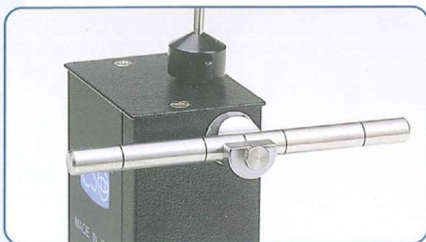
Particolare della fase di taratura del tonometro A 900 Calibration phase detail of the A 900 tonometer
