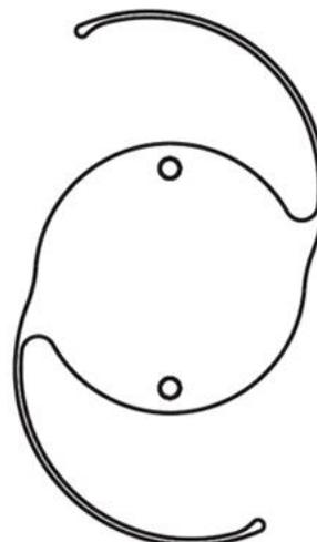
Los lentes intraoculares son implantes ópticos para la lente cristalina humana en la corrección visual de la afaquia. La óptica de la lente está cortada en torno de PMMA con propiedades de bloqueo de rayos UV.
